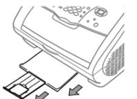
C. Zur Verwendung von A4-Papier klappen Sie den Papierstopper in der Verlängerung der Ablage aus.
