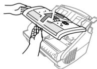
C. Fassen Sie die Trommeleinheit an den beiden Griffnasen und setzen Sie sie in das Gerät ein.
