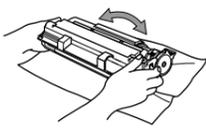
! Um Beschädigungen zu vermeiden, sollten Sie die Trommel nicht länger als einige Minuten dem Licht aussetzen.
