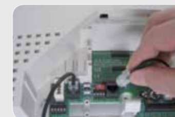
Unter der Gehäuseabdeckung steht viel Platz für die Anschlusskabel und Erweiterungsmodule (s. Seite 13) zur Verfügung.
