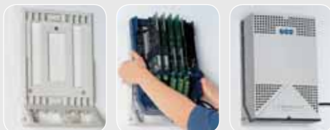
Die Montage des Systems ist denkbar einfach: Chassis an die Wand schrauben, Baugruppenträger aufrasten, mit Modulen bestücken, Deckel aufsetzen, fertig.
