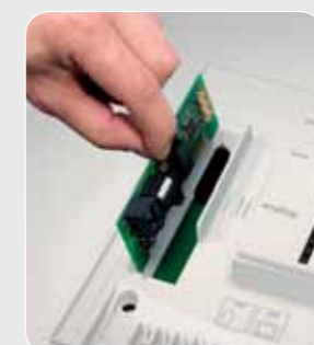
Erweiterungsmodul für interne Teilnehmer (analog oder S 0 oder U 0 ) oder einen ISDN-Amtport (s. Seite 13).
