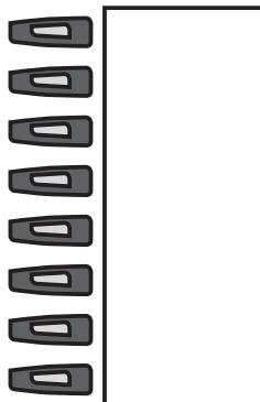
Las **teclas de función** situadas junto a las etiquetas rotulables son teclas que se pueden programar por ejemplo para la marcación rápida o el manejo de las funciones del teléfono. Con cada tecla dispone de dos niveles para la asignación de funciones.
