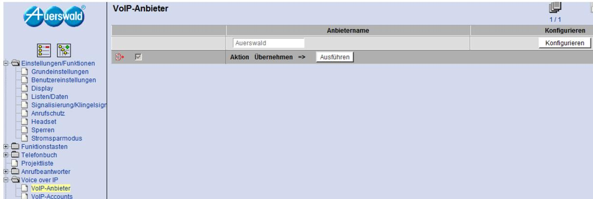
Als Registrar wird die IP Adresse der entfernten Telefonanlage eingetragen.
