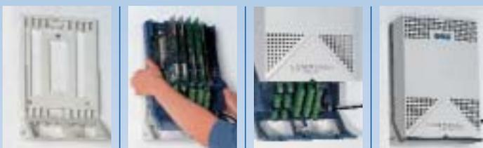
So einfach lässt sich der *COMmander Basic* installieren, umbauen und erweitern: Das Chassis an die Wand schrauben, Baugruppenträger aufrasten, mit Modulen bestücken, Deckel drüberschieben und fertig. Trotz der kompakten Bauweise bietet das Gehäuse genügend Platz für übersichtliche Verdrahtung und Beschriftung, für optimale Belüftung der Elektronik sowie für spätere Erweiterungen oder Umbauten.
