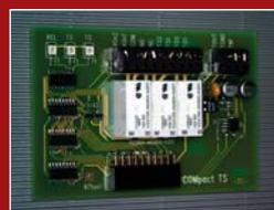
Mit dem COMcompact 2S-Modul erweitern Sie Ihre COMcompact 4410 USB flexibel um einen festen internen und einen variablen S0-Port (extern/intern). Zum Anschluss von Systemtelefonen oder anderer ISDN-Geräte stehen abnehmbare Klemmen und je eine Westernbuchse (RJ-45) zur Verfügung.
