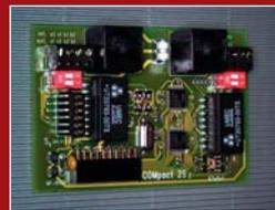
Mit dem COMcompact TS-Modul schließen Sie eine Türstation mit einem Türöffner und zwei Klingel-eingängen an. Zusätzlich steht ein Schaltrelais zum Fernschalten elektrischer Geräte zur Verfügung. Wird keine Türstation verwendet, können 3 Schaltrelais genutzt werden. Die COMcompact 2206 USB kann mit einem und die COMcompact 4410 USB mit 2 COMcompact TS-Modulen nachgerüstet werden.
