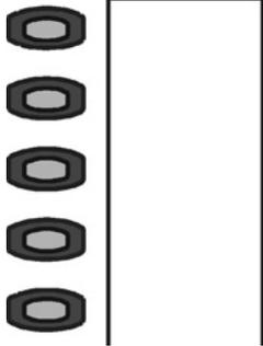
Die **Funktionstasten** neben dem Beschriftungsschild sind programmierbare Tasten z. B. für Zielwahl oder die Bedienung von Telefonfunktionen. Mit jeder Taste stehen Ihnen zwei Ebenen für die Belegung mit Funktionen zur Verfügung.
