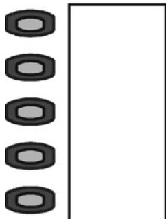
Las **teclas de función** situadas junto a las etiquetas rotulables son teclas que se pueden programar por ejemplo para la marcación rápida o el manejo de las funciones del teléfono. Con cada tecla dispone de dos niveles para la asignación de funciones.
