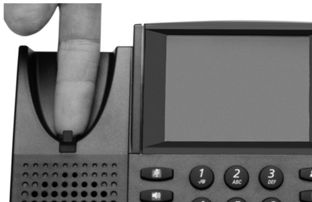
Abb. 4: Einsatz nach unten drücken
